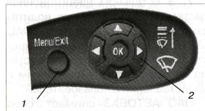
Рис. 2. Внешний вид правого подрулевого переключателя
